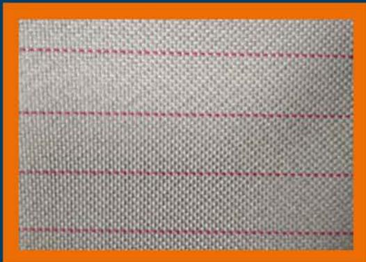
Создаётся из Е-стекла с проволочным плетением из нержавеющей стали и покрытием слоем полиуретана. Благодаря высокой плотности, армированию и специальному плетению, используется для производства противопожарных штор большого размера (премиум).
